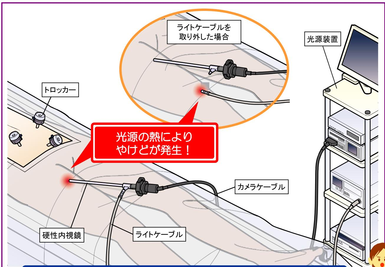
内視鏡の先端部や、内視鏡から取り外したライトケーブルの先端部は、光源装置の電源を切ってからもしばらくの間、熱を持っています！
